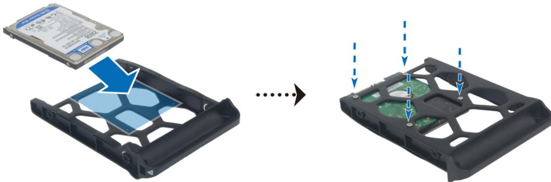
4 Asegúrese de que el lado que lleva la marca "UP" está colocado hacia arriba e inserte la bandeja del disco duro en el receptáculo de disco duro vacío. Debe escuchar un chasquido cuando la bandeja quede bloqueada en su sitio.
